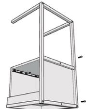
**4** Una vez asegurados los 4 tornillos centrales del cuerpo del mueble a la estructura, colocar el resto de tornillos No. 5 para fijarla completamente, apóyate con la llave allen para fijar todos los tornillos.
