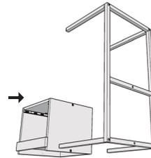
**3** Primero aseguramos el cuerpo del mueble a la estructura con los tornillos No. 2. Realiza el mismo porcedimiento en el segundo poste de la estructura.
