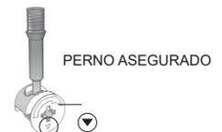
El perno directo a madera, se coloca con ayuda de un desarmador ( no incluido ). Para saber que está completamente atornillado, debemos girar el desarmador hasta que el perno deje de girar.
